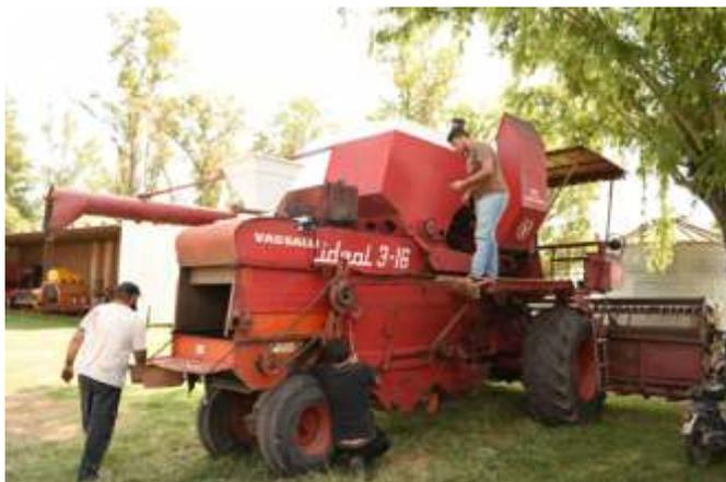
**Imagen 7:** Primer ensayo del Prototipo, cosechando trigo y sembrando soja al voleo.
